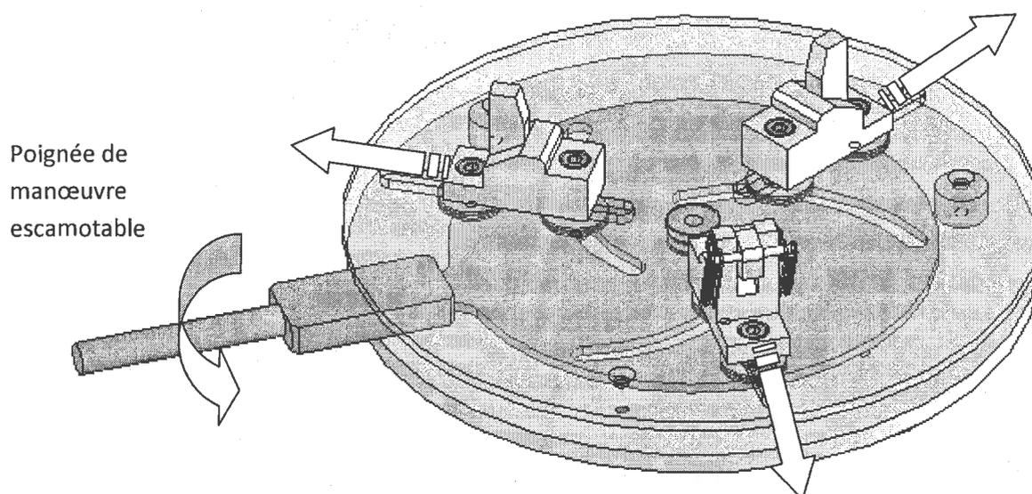
Des blocs de rondelles Belleville (voir ci-dessous) assurent le maintien en position des supports par adhérence sur le plateau supérieur.
