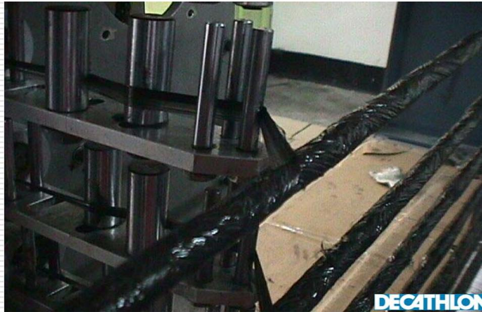
Le chariot permet à la fibre de balayer toute la longueur du shaft, synchronisé par rapport à la rotation du mandrin pour mieux contrôler le recouvrement des mèches
