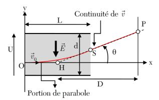
La particule préalablement accélérée pénètre en O avec une vitesse initiale  $\overrightarrow{v_0} = v_0 \overrightarrow{u}_x$ . On note d l'espacement entre les armatures de longueur L et on suppose le champ E uniforme dans l'espace entre les armatures et nul ailleurs. On rappelle que  $\overrightarrow{E} = -\frac{U}{d} \overrightarrow{u}_y$ .
